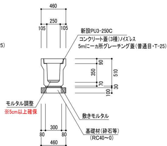
※側溝の蓋版設置については、側溝本体継目と蓋版端部を合わせること。
